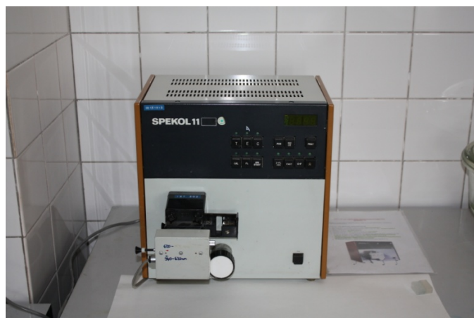
Spektrofotometer SPEKOL 11 – slúži na spektrofotometrické stanovenia v UV a VIS oblasti.
