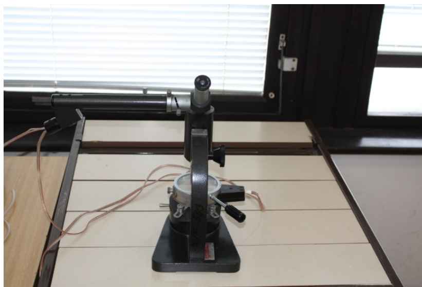
Bodotávok – slúži na stanovenie teploty topenia tuhých látok.
