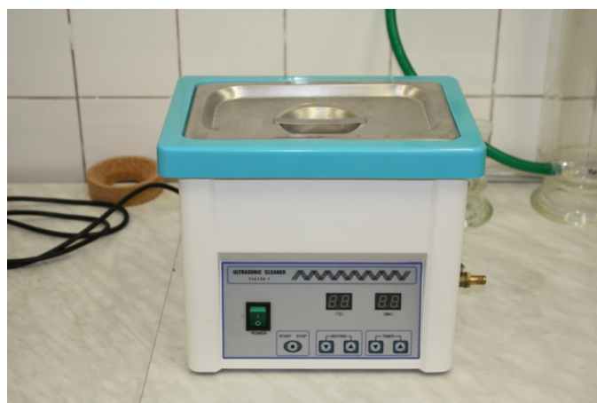
Sonifikačná vanička – pre štúdium AOP procesov
