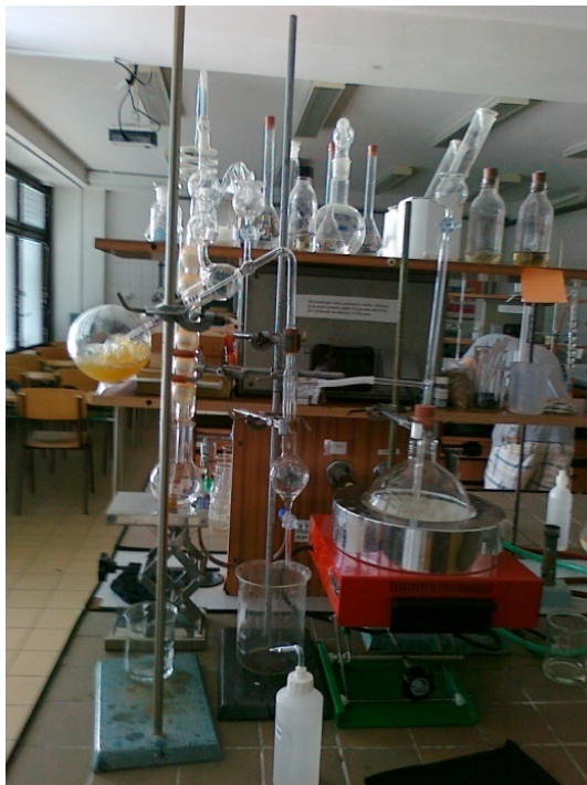
Kjehdahlova aparatúra – slúži na stanovenie celkového dusíka v biologickom materiáli, kaloch, pôdach a i.
