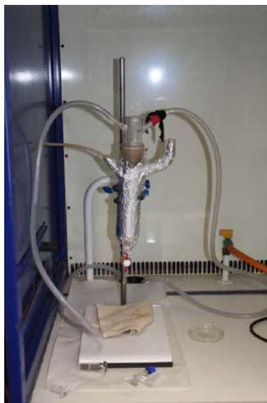
UV fotoreaktor – pre štúdium AOP procesov
