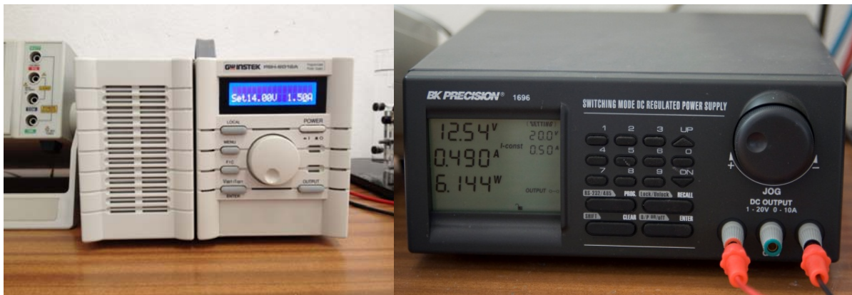
Jednosmerný programovateľný spínaný zdroj GW Instek PSH-6012A s výstupným napätím 0-60 VDC a s prúdovou zaťažiteľnosťou až 12 A a jednosmerný programovateľný zdroj BK PRECISION 1696 s výstupným napätím 1-20 VDC, prúdom 0-10A
