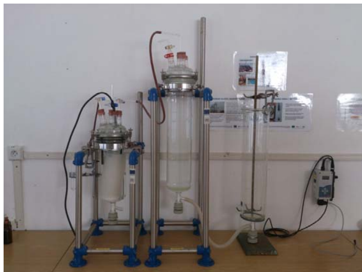
Laboratórna zostava výroby chlóru pomocou fotovoltaického zdroja
