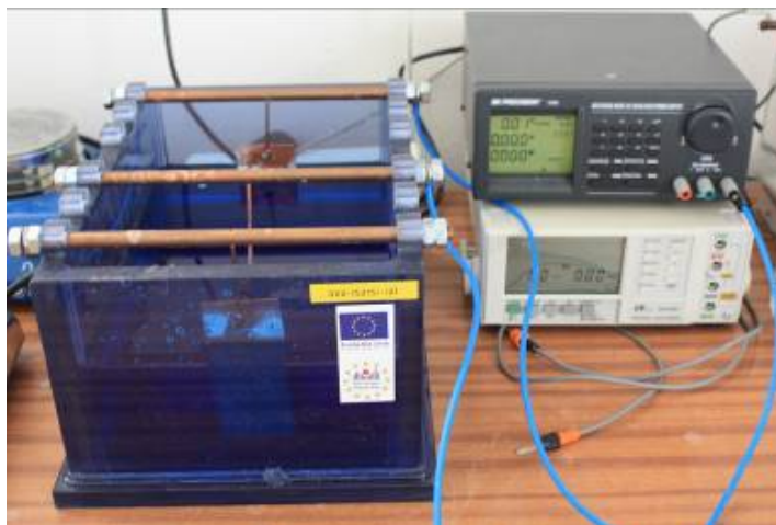
Laboratórna zostava galvanického pokovovanie pomocou fotovoltaického zdroja
