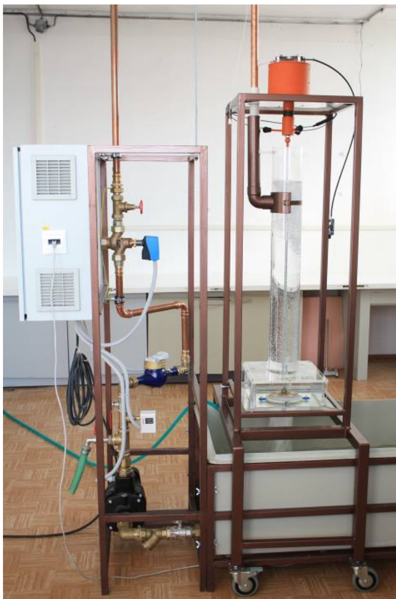
Merací stand čerpaceho okruhu na testovanie piko vodných turbín - automaticky regulovaný prietok simulujúci malý vodný tok, sledovanie krútiaceho momentu s a bez záťaže, sledovanie otáčok a elektrického výkonu
