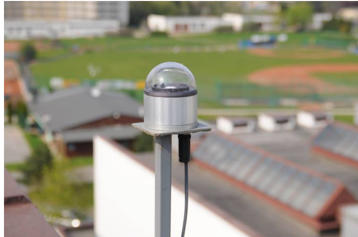
Snímač na meranie intenzity slnečného žiarenia
