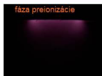
Preionizačný mód ( \sim 300 V, \sim 4 mA, \sim 1.2 W) (čierna čiara)
