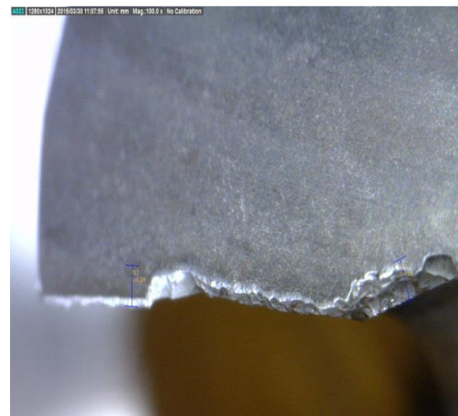
Fig. 2 Cutting edge 2., VB_k = 0.335 mm
