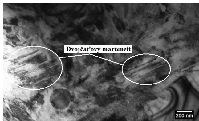
Obr. 8 Snímka z TEM zobrazujúca subštruktúru ocele Vanadis 6 po zmrazovaní 17h
