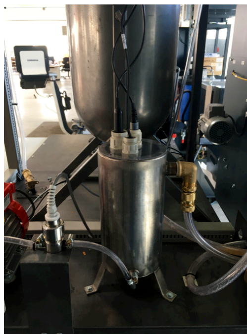
Obr 2 Monitorovací a regulačný systém pre rezné kvapaliny.
