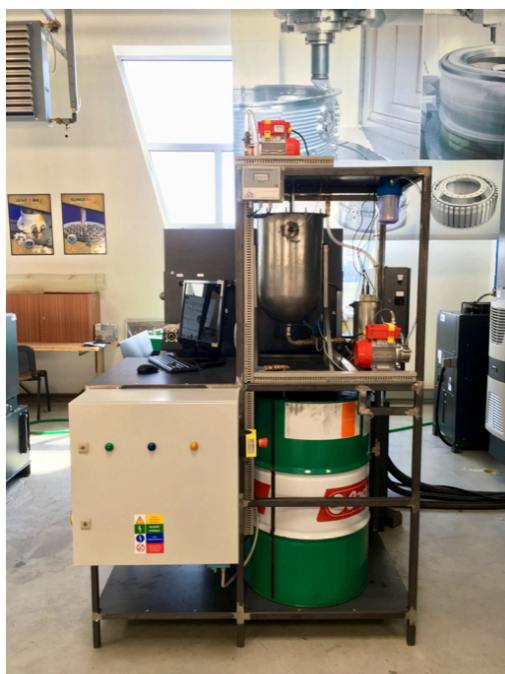
Obr 2 Monitorovací a regulačný systém pre rezné kvapaliny.
