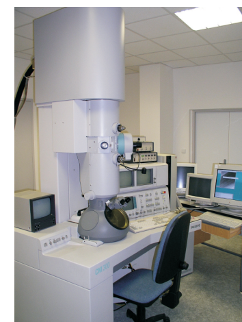
obr. hore: pracovisko prípravy vzoriek obr. dolu: vysokorozlišovací transmissný elektrónový mikroskop
