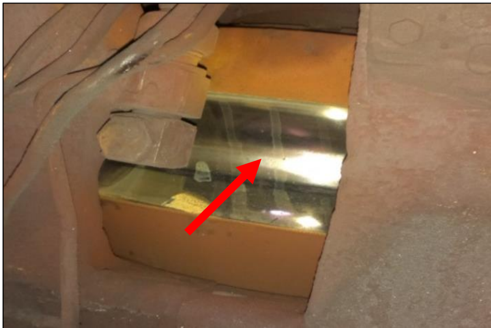
Obr. 1 Typické miesto merania pomocou TC sondy OMEGA – stred kalibra valca
