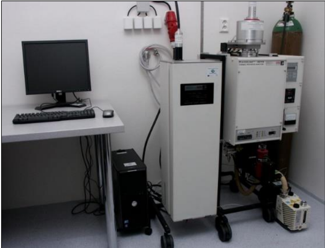
Obr. 3 Zariadenie pre meranie termofyzikálnych vlastností FlashLine 4010
