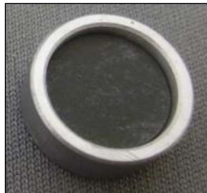
Obr. 5 Vzorka ošetrená grafitovým povlakom a umiestnená v molybdénovom krúžku
