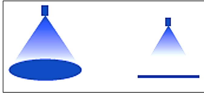
Obr. 19 Porovnanie dýz z hľadiska tvaru lúča (vľavo – kužeľová, vpravo – vejarová)
