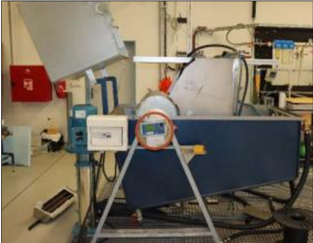
Obr. 7 Zariadenie pre meranie HTC povrchu valca
