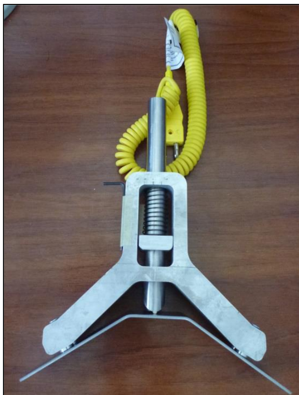
Obr. 2 Prototypové zariadenie pre meranie povrchovej teploty kalibra
