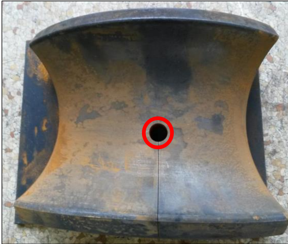
Obr. 6 Pracovný valec a miesto odobraných vzoriek
