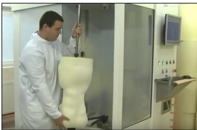
Obr. 9 Vyfrézovaný model trupu z polyuretánu (Neoprot, 2017).
