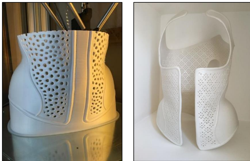
Obr. 3 Skoliotický korzet vyrobený technológiou FDM (WASP 2016).
