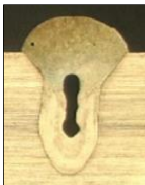
Obr. 2 Keyhole pórovitosť (Xiao, R., Zhang, 2014)
