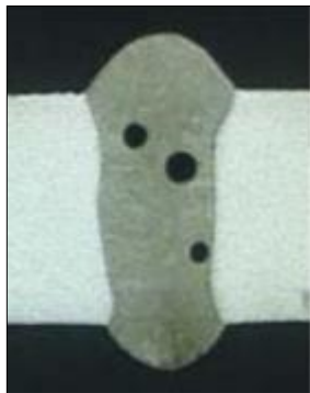
Obr. 1 Metalurgická pórovitosť (Xiao, R., Zhang, 2014)
