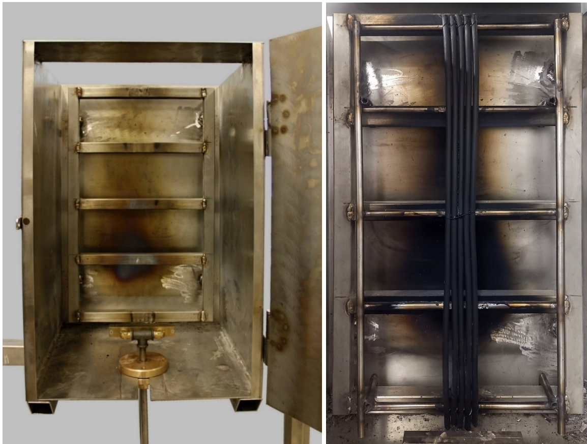
Obrázok 3: Skúšobná komora elektrických káblov a uchytenie elektrických káblov
