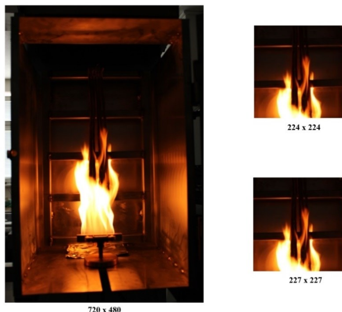
Obrázok 4: Orežanie elektrického kábla CHKE-R J3x1,5 B2 ca (s1, d1, a1) VUKI 2021
