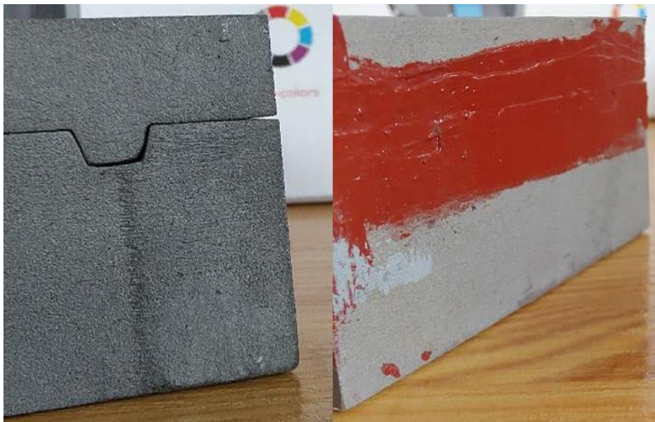
Obrázok 14 Formy pred a po utesnení vysokoteplotným silikónom
