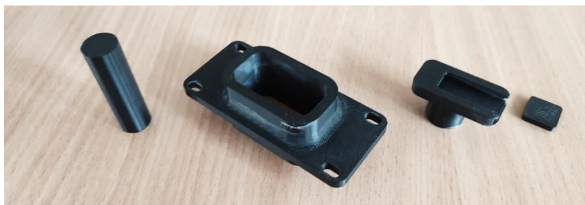
Obr. 9 Komponenty prípravku vyrobené 3D tlačou
