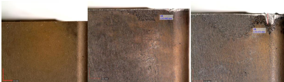
Obr. 20: Vývoj šírky plošky opotrebovania VB_N
