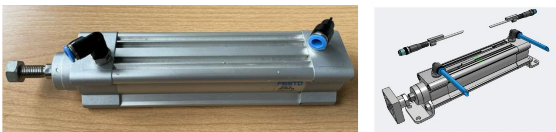
Obr. 18 Štandardizovaný dvojčinný valec podľa normy ISO 15552 DSBC-32-100-PPSA-N3, ktorý sa používa na predmet skúmania a renos 3D modelu vytvoreného pomocou nástroja Festo Design Tool 3D a exportovaného vo formáte NX prt
