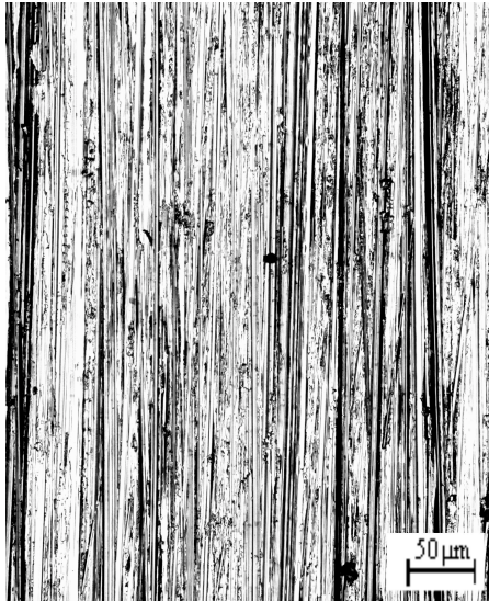
Obr. 2 Povrch vzorky po mechanickom brúsení papierom zrnitosti číslo 800
