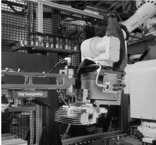
Obr. 3 "Začísťovanie" stôp po deliacej ploche na odliatku, odliatok je upnutý v chápadle robota
