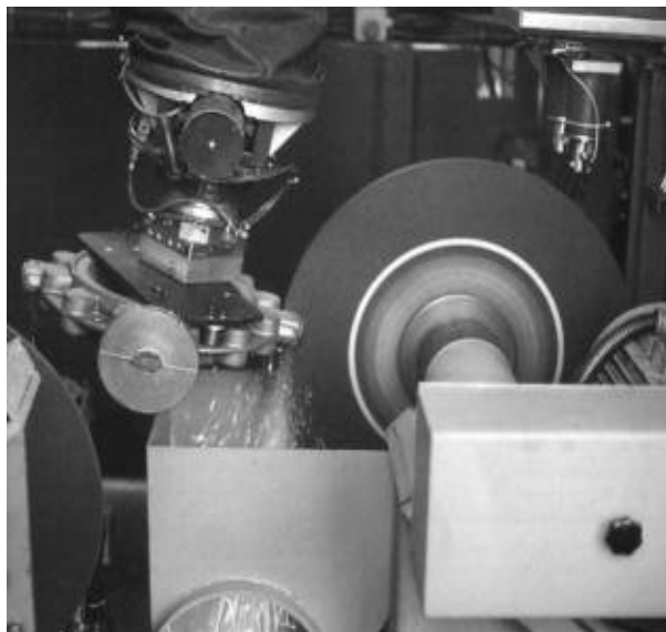
Obr. 4 Priemyselný robot nesúci súčiastku pri odstraňovaní náliatkov
