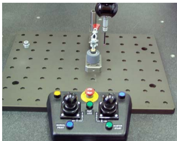
Obr. 2. Detail merania odchýlky kruhovitosti a valcovitosti na súradnicovom meracom prístroji G – 90C
