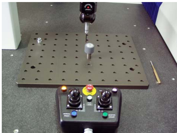
Obr. 2. Detail merania odchýlky kruhovitosti a valcovitosti na súradnicovom meracom prístroji G – 90C
