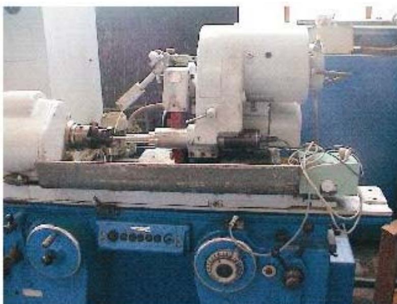
Obr. 2 Vodorovná brúska na otvory pre oba spôsoby brúsenia technickej keramiky
