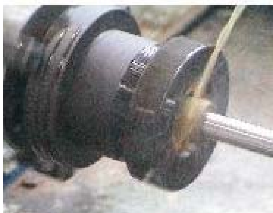
Obr. 3. Brúsenie keramického krúžku upevneného v strediacom upínači
