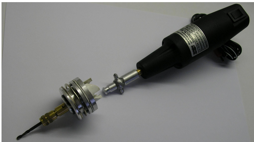
Obr. 12. Rozpojený systém automatizovanej výmeny nástroja
