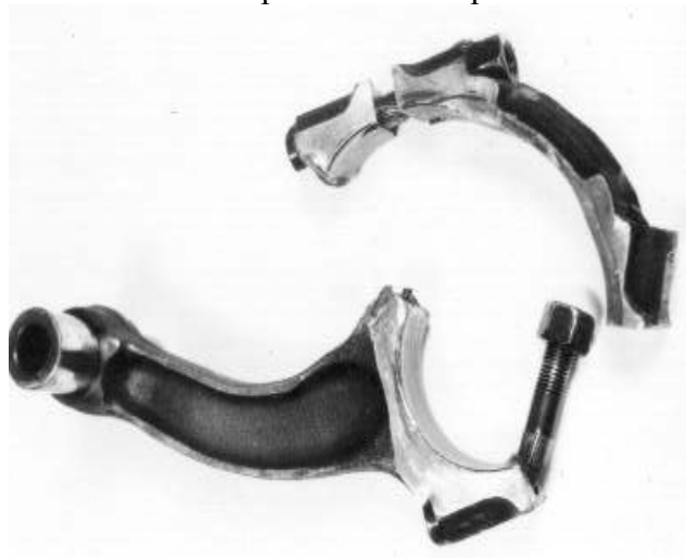
Obr. 1. Celkový pohľad na poškodenú ojnicu, zmenšené 2,4x
