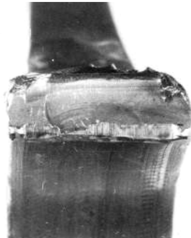
Obr. 2. Pohľad na lomovú plochu ojnice, zväčšené 2,1x
