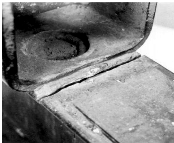
Obr. 15. Pohľad na poškodený pozdĺžnik prívesu, zmenšené 6,5x
