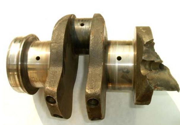
Obr. 9. Prehľadný pohľad na zlomený kľukový hriadeľ. Zmenšené 4,7x
