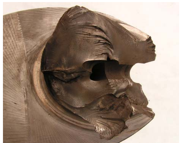
Obr. 11. Lomová plocha kľukového hriadeľa. V ľavej časti čapu hriadeľa pozorovať vyhriatie. Zmenšené 2,8x.
