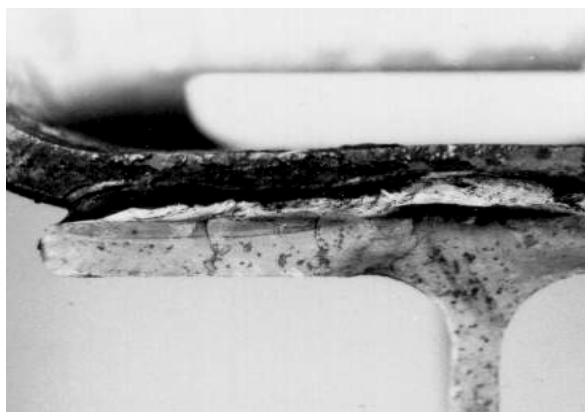
Obr. 18. Detail zvaru a lomovej plochy po rozpílení pozdĺžnika, zmenšené 1,1x
