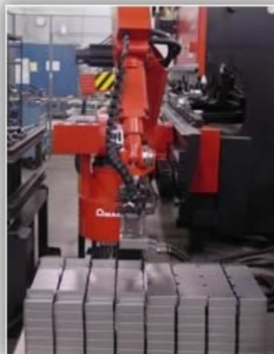
Obr. 2: Robot ukladá hotové výlisky
