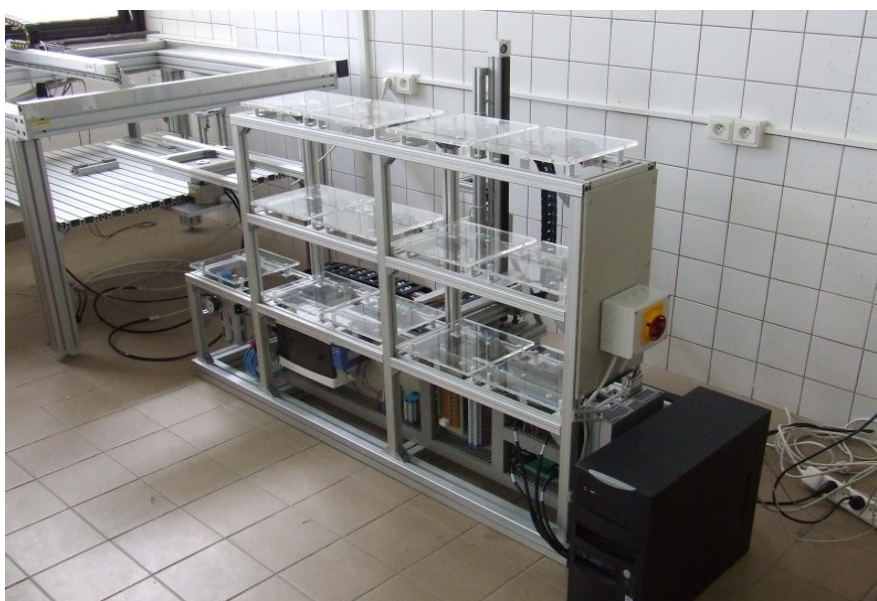
Obr. 2: Regálový zakladač pružnej výrobnno-montážnej bunky
